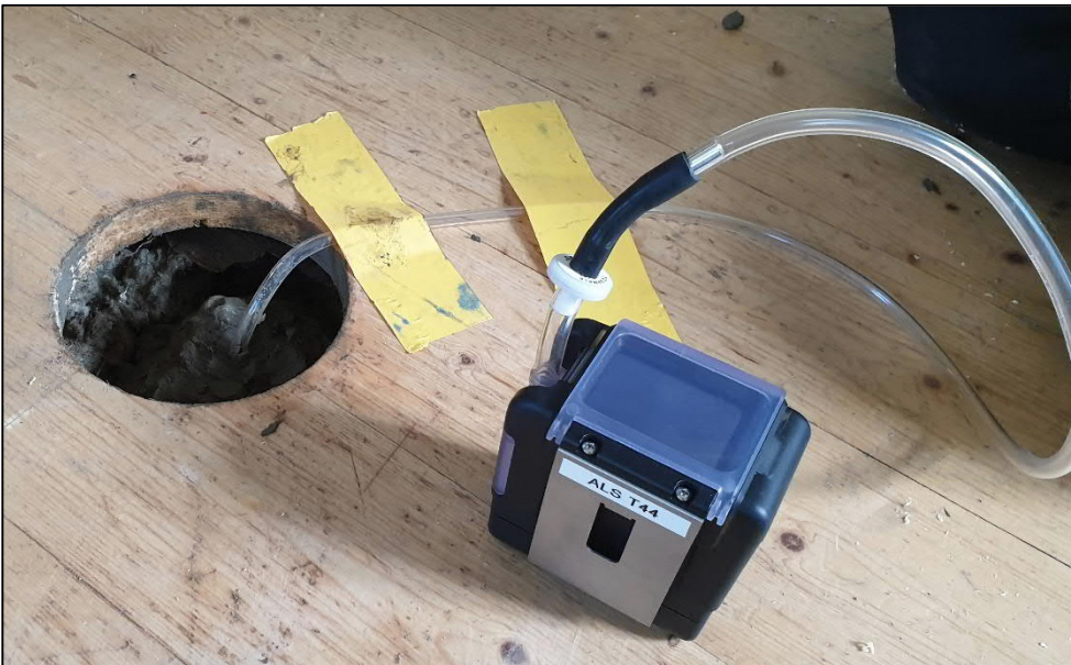
Figur 12. Porluftsmätning i markplan under före detta tvättstuga, provpunkt NC2008.
