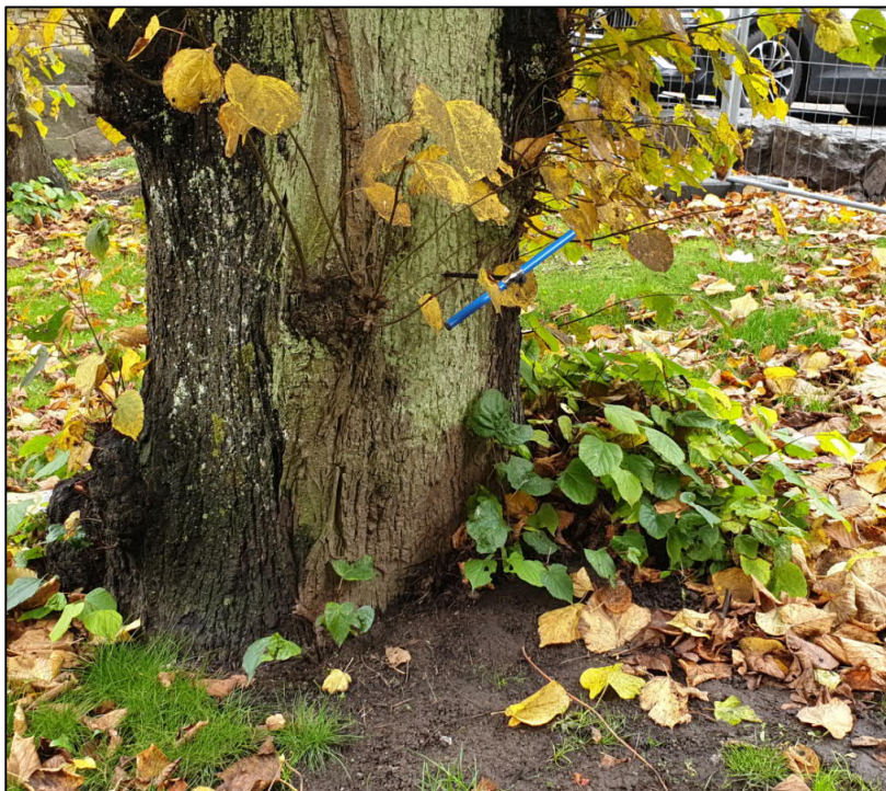
Figur 6. Provtagning av träd med hjälp av tillväxtborr, provpunkt NC2009.
